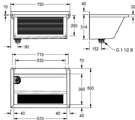
SIRIUS Waschtrog für Wandmontage, Chromstahl, Oberfläche hochglanzpoliert, Materialstärke Waschtrog 0,8 mm / Seitenpaneele 1,2 mm, Seitenpaneele mit integrierten Wandkonsolen, fugenlos verschweißt, Frontschürze mit Längsriffel, abgesenkte Armaturenbank 70 mm, ohne Überlauf, 40 mm Wandzarge, Ablauf links, Standrohrventil G 1 1/2 B aus Kunststoff, entnehmbares Eckschutzblech, inklusive Befestigungsmaterial.
